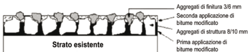
7. La composizione tipo della membrana MBSM
