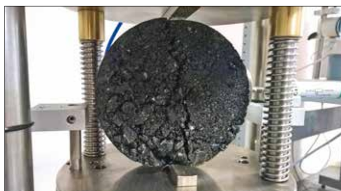
12. La prova di trazione indiretta INN laboratorio
