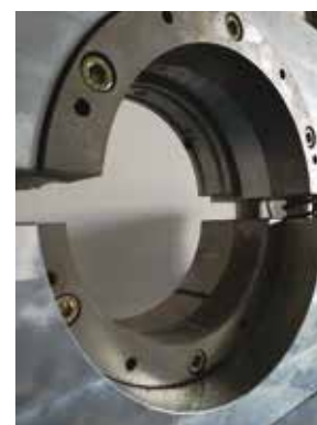
3A e 3B. Particolari del telaio di prova e della semiluna di taglio
