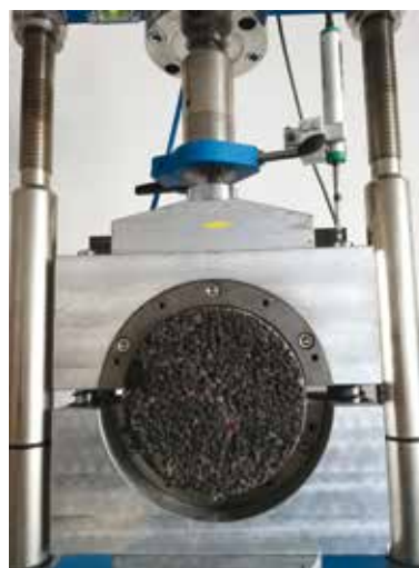
3A e 3B. Particolari del telaio di prova e della semiluna di taglio
