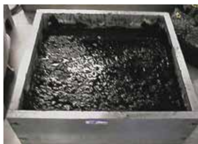
6. L'aspetto dell'interfaccia ricoperta di emulsione bituminosa
